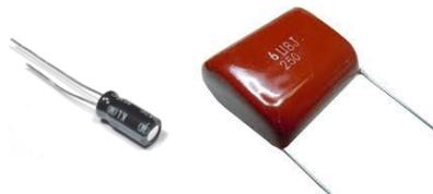
Figura 11. Capacitor electrolítico y capacitor de poliéster.
